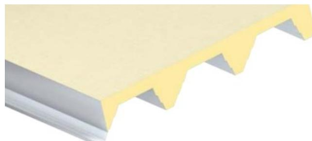
Do sendvičových střešních panelů s nosným plechem na interiérové straně a s vrchní vrstvou na bázi minerálních vláken na vrchní straně jádra se hydroizolační fólie mechanicky kotví ke spodnímu plechu panelu, případně lze fólii k panelu plošně nalepit.
