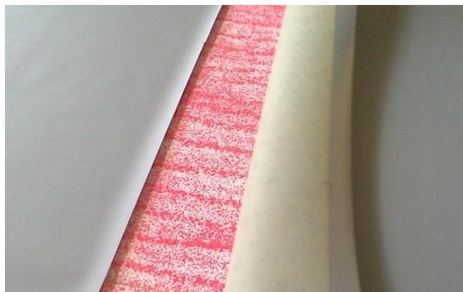
Podklad, k němuž má být povlaková hydroizolace přilepena, musí být sám natolik pevný, aby byl schopen dlouhodobě přenášet síly na ni působící. Podklady pro lepení musí být čisté, suché, bez prachu, mastnoty, volného nebo lepeného posypového materiálu, nesoudržných nátěrů, zvětralé stávající hydroizolace či jiných materiálů snižujících soudržnost lepených vrstev.
