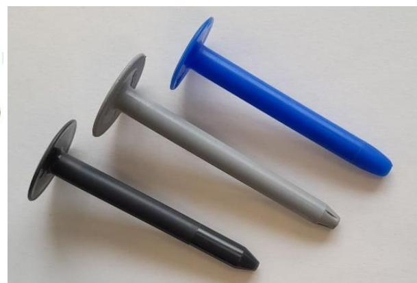
**Popis výrobků:** Typický kotevní prvek se podle typu podkladu skládá ze šroubu, případně nýtu a plastového teleskopu nebo ocelové přítlačné podložky. Šrouby jsou obvykle vyrobeny z ušlechtilé uhlíkové oceli s ochranou proti korozi nebo z austenitické nerezové oceli. Přítlačné ocelové podložky jsou vyrobeny z ocelového plechu s vhodnou povrchovou úpravou (např. Aluzink), plastové teleskopy z vysoce jakostního polypropylenu, polyamidu případně polyetylenu.
