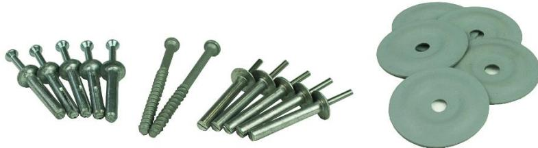
**Popis výrobků:** Typický kotevní prvek se podle typu podkladu skládá ze šroubu, případně nýtu a ocelové přítlačné podložky. Šrouby jsou obvykle vyrobeny z ušlechtilé uhlíkové oceli s ochranou proti korozi nebo z austenitické nerezové oceli. Přítlačné ocelové podložky jsou vyrobeny z ocelového plechu s vhodnou povrchovou úpravou (např. Aluzink).
