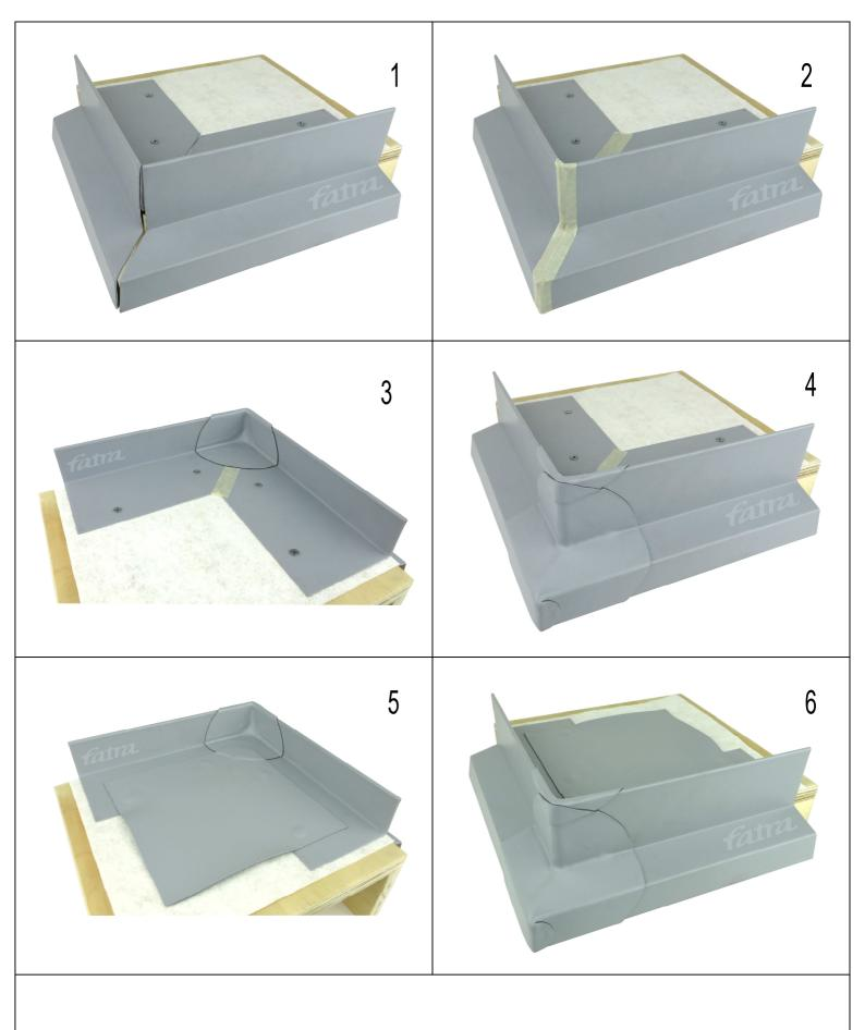
Внешний угол, устройство капельника и большого ограничителя гравийной засыпки из ПВХ металла
