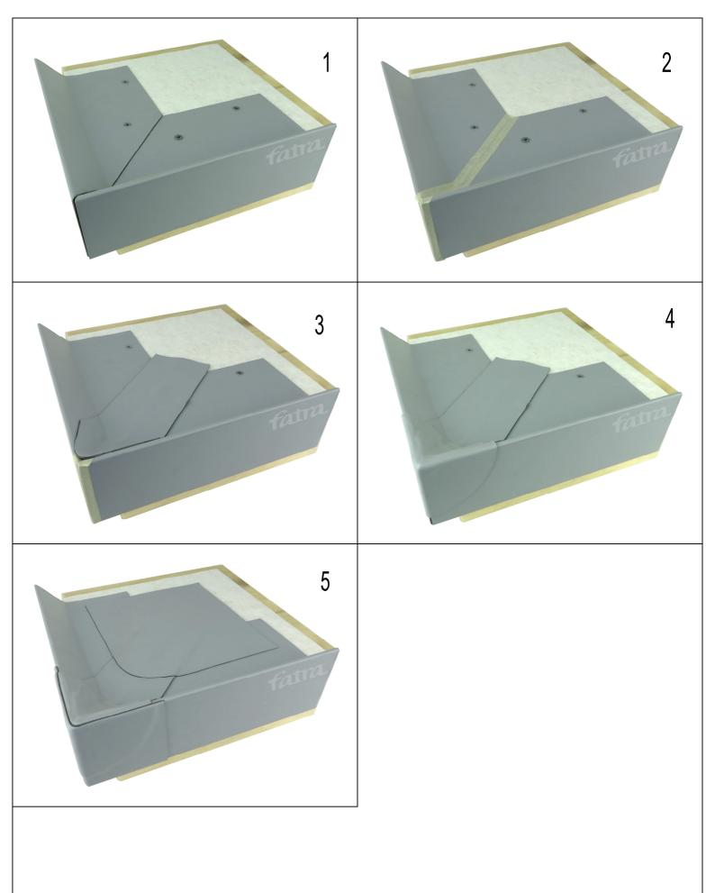
Внешний угол, устройство капельника и малого ограничителя гравийной засыпки из ПВХ металла
