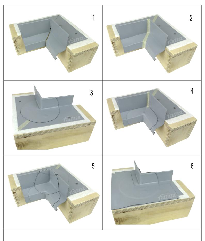
ВНУТРЕННИЙ УГОЛ, УСТРОЙСТВО ОГРАНИЧИТЕЛЯ ДЛЯ ГРАВИЙНОЙ ЗАСЫПКИ ИЗ ПВХ МЕТАЛЛА
