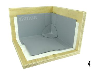
ВНУТРЕННИЙ УГОЛ, УСТРОЙСТВО ПРИМЫКАНИЯ ГИДРОИЗОЛЯЦИИ БАЛКОНА С ПРИМЕНЕНИЕМ УГЛОВ ИЗ ПВХ МЕТАЛЛА
