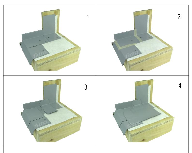
WÄNDEÜBERGANG, GROßer Steinfänger - Inneneckeprofil für Balkone
