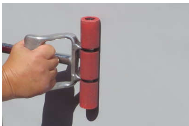
Stlačení lepených ploch ručním válečkem
