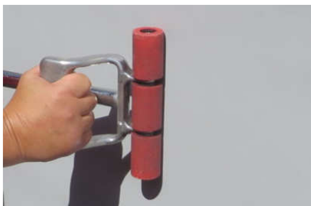
Stlačení lepených ploch ručním válečkem
